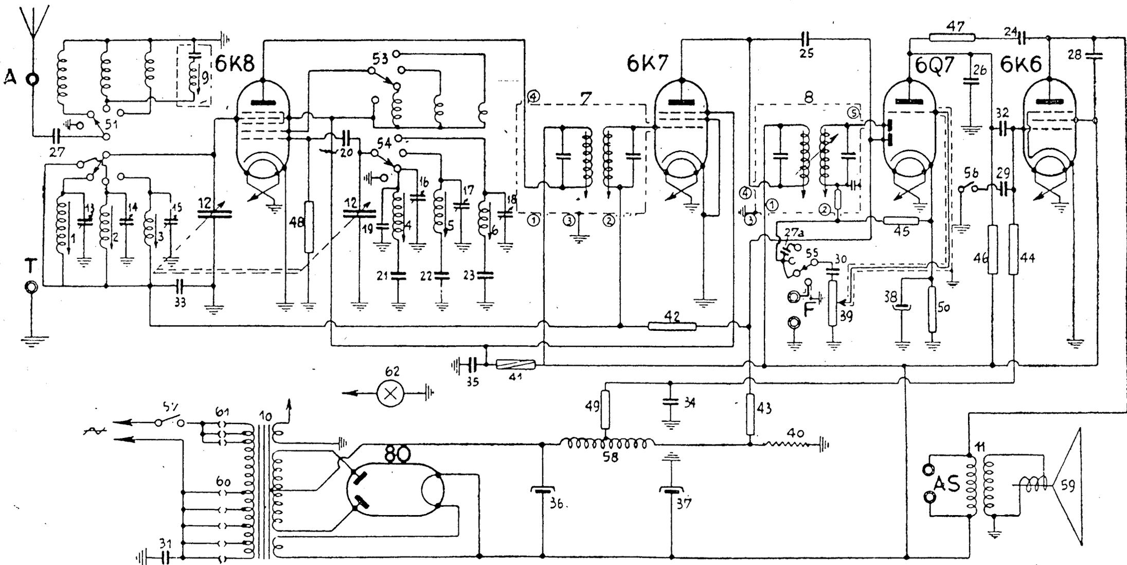
Fig. 234. — UNDA-RADIO. - Mod. Tri-Unda 531. Schema elettrico. (I valori delle resistenze e delle capacità sono riportati nella pagina che segue). Media frequenza: 450 kHz.
